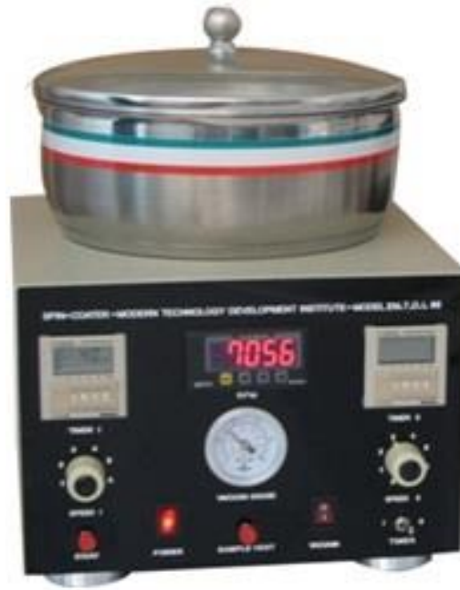
شکل (۳-۹) دستگاه لایه نشانی چرخشی موجود در دانشگاه صنعتی شاهرود
