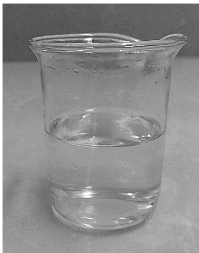
شکل ۴-۶: محلول اولیه تهیه شده در این کار برای لایه نشانی لایه‌های نازک CIS به روش سولوترمال.
