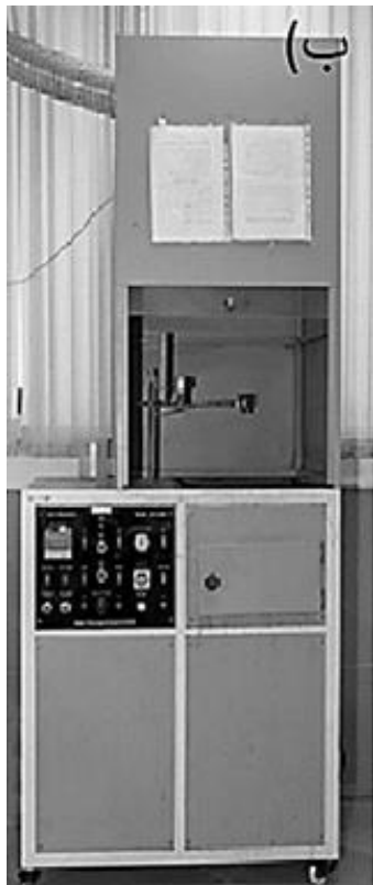
شکل ۲-۲) الف: یک طرحواره از قطعات دستگاه اسپری پایرولیز و ب: تصویری از دستگاه اسپری پایرولیز موجود در دانشگاه صنعتی شاهرود.
