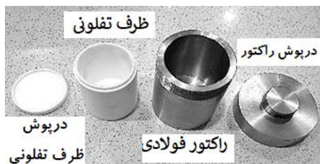
شکل ۱-۲: راکتور ساخته شده از فولاد ضد زنگ و محفظه تفلنی مورد استفاده در این پایان‌نامه.
