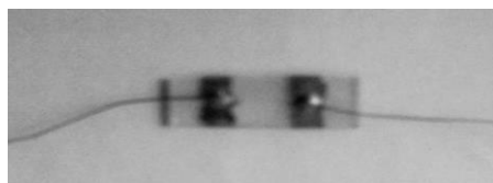
شکل ۲-۹: اتصال فلز-نیمرسانا برای اندازه‌گیری رسانندگی نمونه‌ها.
