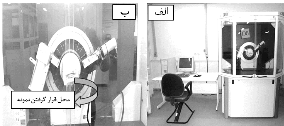
شکل ۲-۶: الف) تصویری از دستگاه پراش پرتو X مدل (D8-Advance)، ب) محل قرار گرفتن نمونه.
