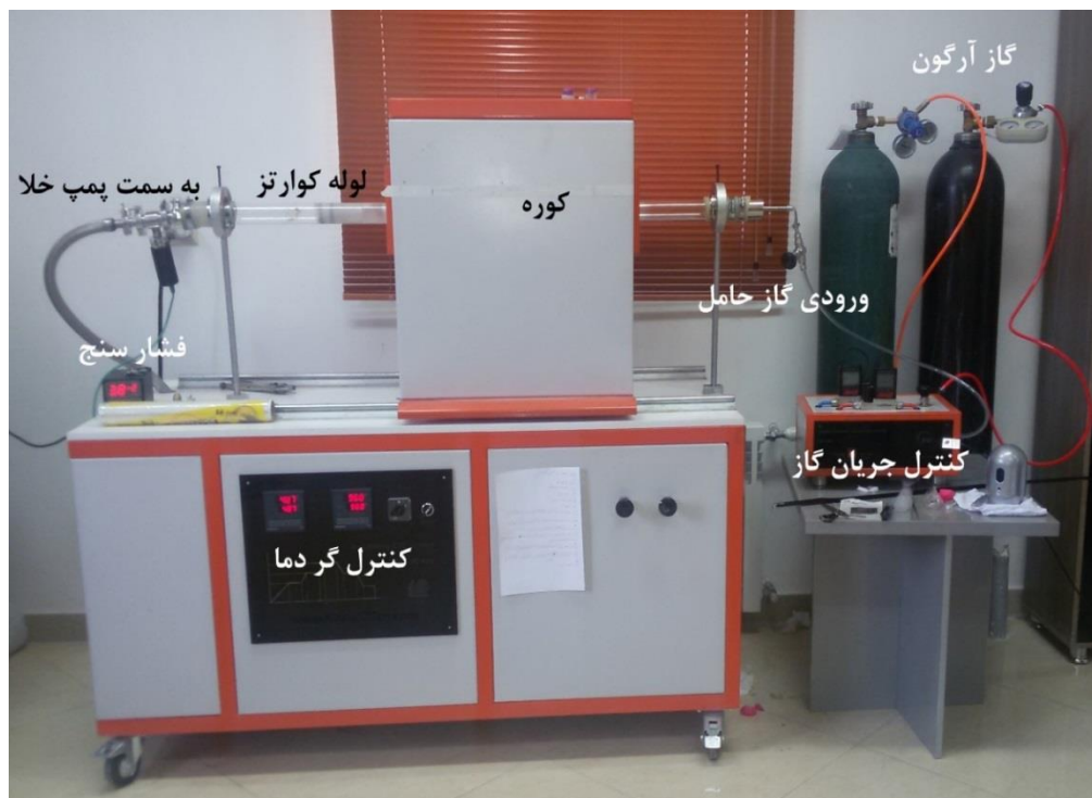
شکل (۴-۶) دستگاه رسوب بخار شیمیایی ریلی RS-CVD
