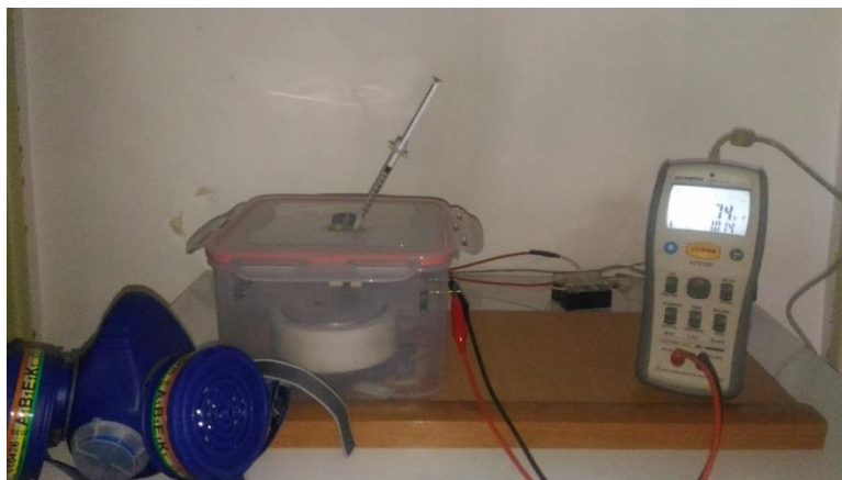
شکل (۴-۱۳) تصویر چیدمان طراحی شده جهت آنالیز های قطعات حسگری خازنی
