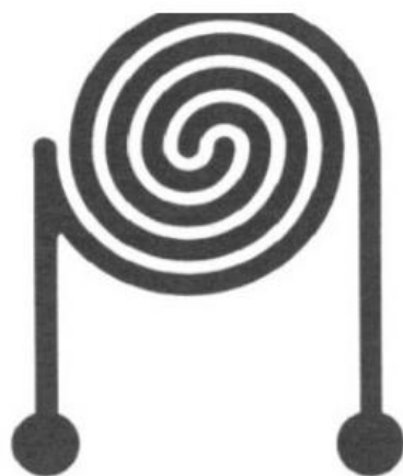
شکل (۳-۵) طرح الکترودهای مارپیچی، الکترودها دارای ضخامت 0,035 میلی متر، عرض 0,3 میلی متر، فاصله 0,14 میلی متر و طول 25 میلی متر هستند.
