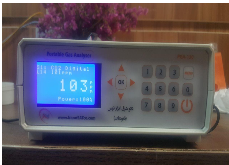
شکل ۴-۷: سنسور نوری برای اندازه‌گیری گاز دی اکسید کربن
