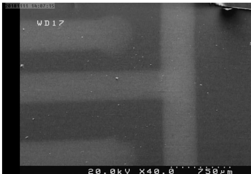
شکل ۵-۵: آنالیز SEM در زوم ۷۵۰ میکرون برای الکتروود شاخه‌ای ۱۵۰ نانومتری
