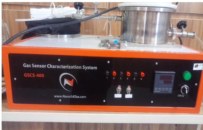
شکل ۵-۸: حسگر گازی مقاومتی با روش افزایش دما و UV
