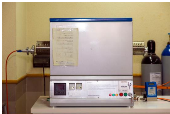
شکل ۳-۵: کوره تیوپی با مدل (YTF1250-30X8) واقع در دانشگاه صنعتی شاهرود.
