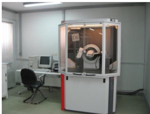
شکل ۱-۲: دستگاه XRD مدل ADVANCE-BRUKER D8 دانشگاه دامغان.
