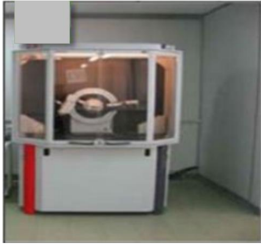
شکل ۲-۳ تصویر دستگاه پراش پرتو ایکس (XRD) واقع در دانشگاه دامغان را نشان می‌دهد.
