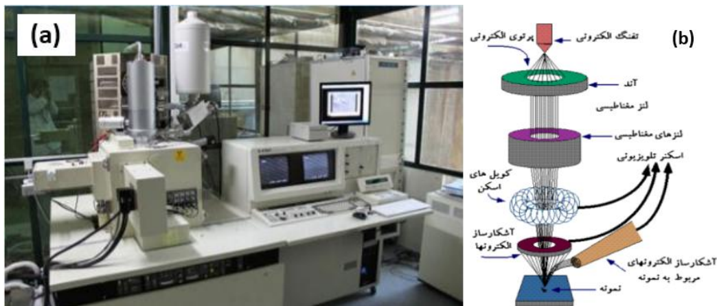
شکل ۱-۲ الف) تصویری از میکروسکوپ الکترونی روبشی اثر میدانی (FESEM , Hitachi S-4160) بکار گرفته شده در دانشگاه تهران. ب) طرح شماتیکی از اجزای داخلی مسیر عبور باریکه تا سطح نمونه.
