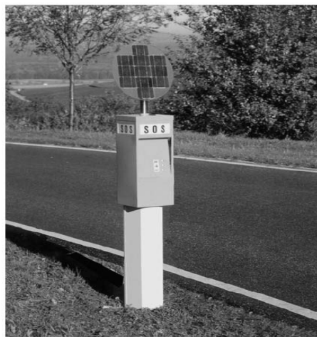
شکل (۳-۱۲): نمونه‌ای از کاربرد اثر فوتوولتایی در تامین برق یک تلفن ثابت بین راهی [۴۹]
