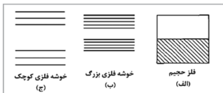
شکل ۲-۱۴: الف) ساختار انرژی یک ماده معمولی به شکل نواری. ب) ساختار انرژی نانو ذرات بزرگ شامل ۱۰۰ اتم. ج) ساختار انرژی نانو ذرات کوچک شامل ۳ اتم
