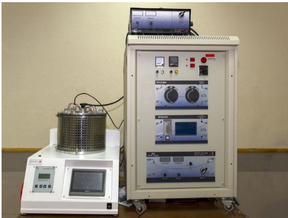
شکل ۳-۱: تصویر دستگاه لایه نشانی ترکیبی اسپاترینگ و تبخیر حرارتی DST2-T مورد استفاده در این پایان نامه
