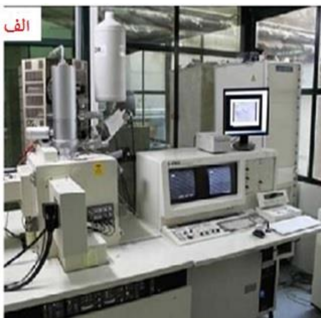
شکل ۳-۴: (الف) میکروسکوپ الکترونی روبشی گسیل میدانی (FESEM) مورد استفاده در این پایان نامه (ب) طرح واره اجزاء داخلی مسیر عبور باریکه الکترونی تا سطح نمونه [۴۸]
