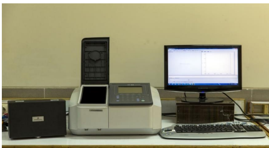
شکل ۳-۷: دستگاه اسپکتروفوتومتر Shimadzu (UV-1800) استفاده شده در این پایان‌نامه
