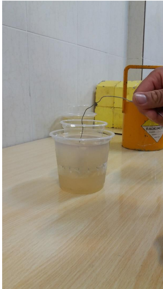
شکل ۳-۲۰. فانتوم ژل پلیمر MAGIC با حضور محلول نانوذرات طلا به طور یکنواخت
