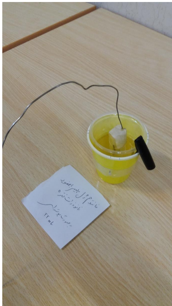
شکل ۳-۲۱. فانتوم ژل پلیمر MAGIC با حضور محلول نانوذرات نقره به صورت پوسته‌ای.
