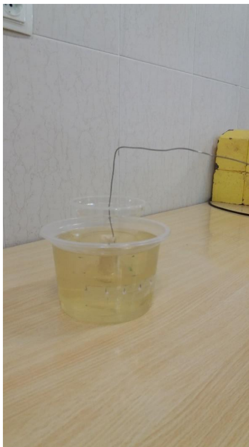
شکل ۳-۱۸. فانتوم ژل پلیمر MAGIC و قرار گرفتن چشمه ایریدیم در مرکز آن و قرص‌ها TLD در اطراف فانتوم
