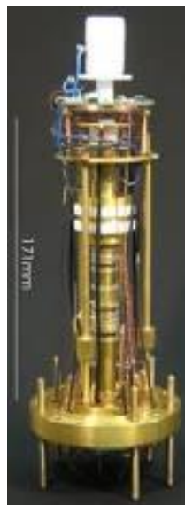
شکل ۱-۳-۲: تله‌ی یونی پنینگ ساخته شده در مرکز ماکس پلانک آلمان [۱۱].
