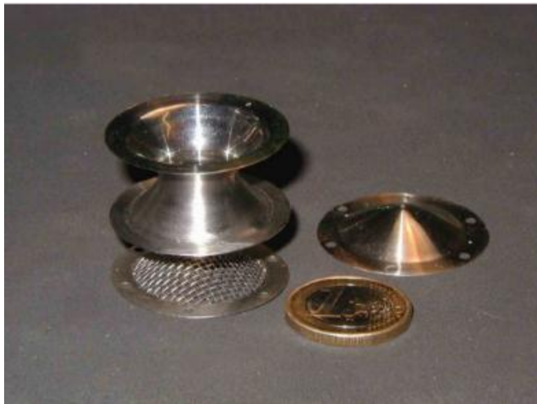
شکل ۲-۶-۱: الکترودهای تله‌ی یونی پنینگ و اندازه آن در مقایسه با سکه.
