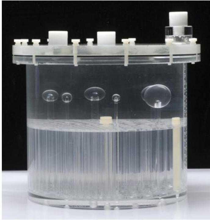
شکل ۳-۱۱: فانتوم جیزک مورد استفاده برای ارزیابی کیفیت تصویر [۱۸].
