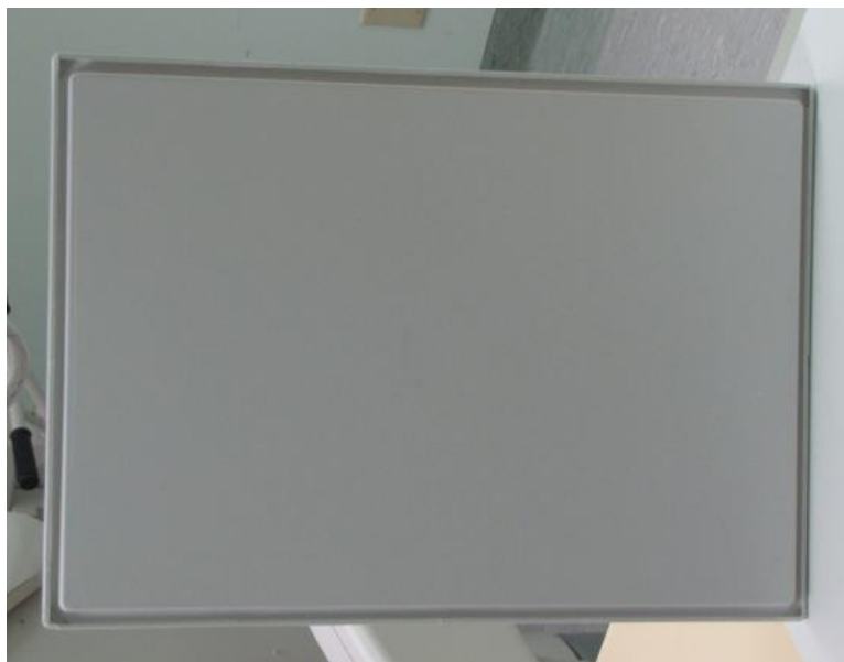
شکل ۳-۲: شکلی از چشمه اغتشاشی ^{57}\text{Co} [۱۸].
