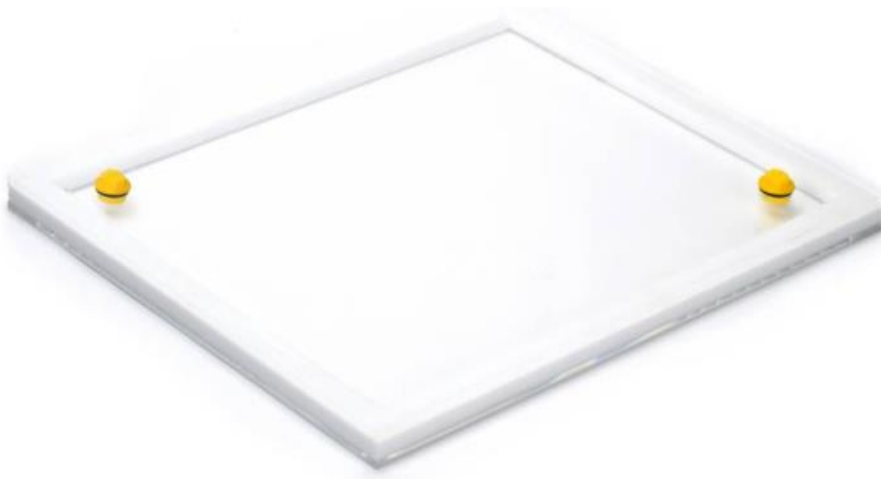
شکل ۳-۳: نمونه‌ای از فانتوم میدان اغتشاشی با قابلیت پر شدن [۱۸].
