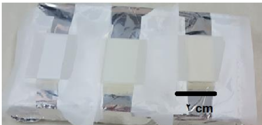
شکل ۱۲-۴: لایه های کشیده شده از خمیر \text{TiO}_2 روی شیشه رسانا. در شکل ۳ لایه وجود دارد که اطراف آنها با چسب اسکاچ پوشیده شده و لایه نازکی از خمیر \text{TiO}_2 روی آنها کشیده شده است.
