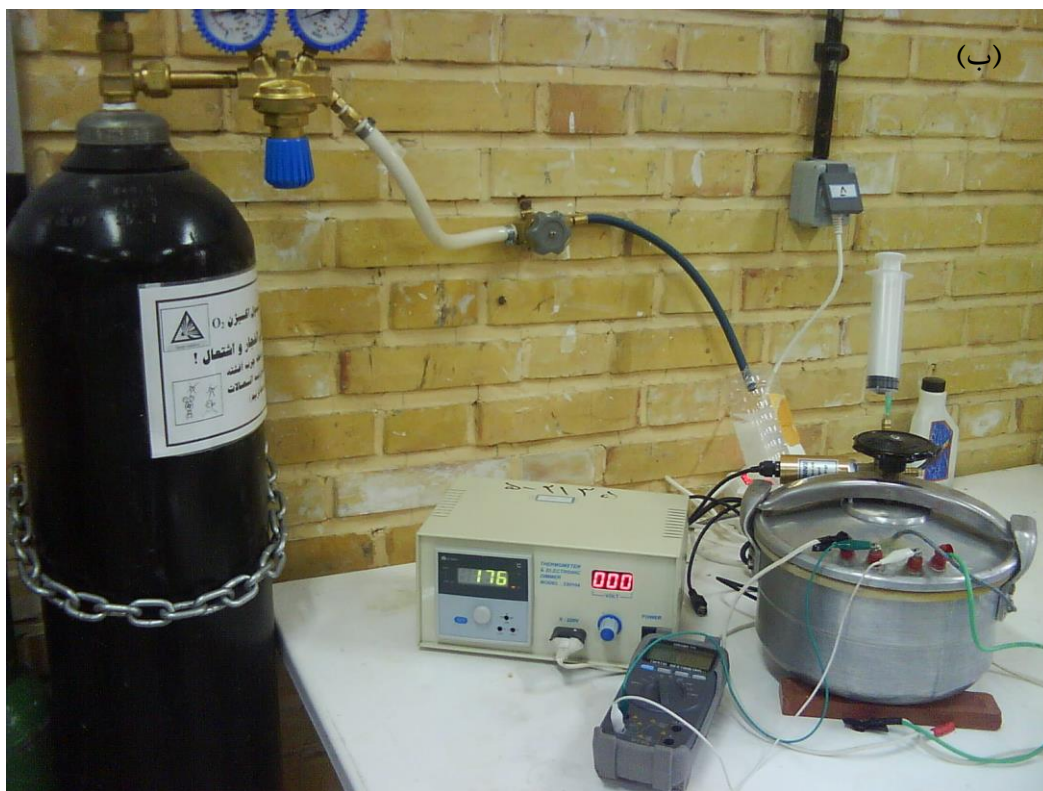
شکل ۴-۱۳: تصویری از سیستم حسگری در آزمایشگاه برای اندازه‌گیری حساسیت با تغییر تراکم گاز
