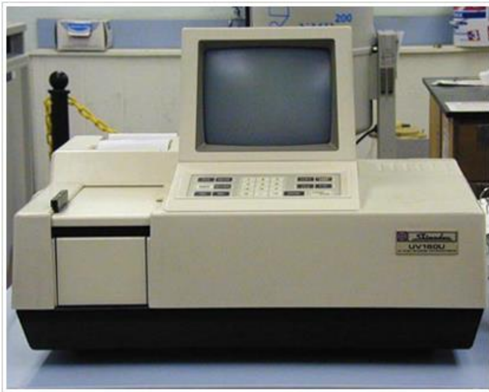
شکل ۴-۴: دستگاه طیف سنجی UV-Vis مدل (UV-160) Shimadzu گروه شیمی دانشگاه صنعتی شاهرود
