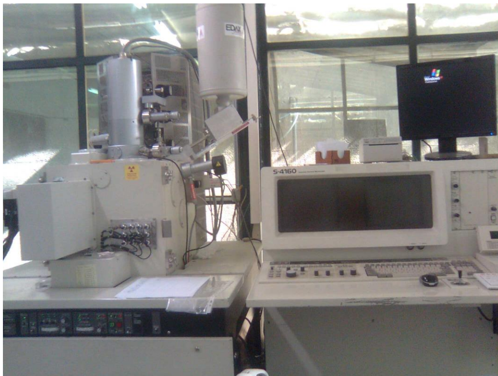
شکل ۴-۳: تصویر دستگاه میکروسکوپ الکترونی روبشی در آزمایشگاه میکروالکترونیک دانشکده فنی دانشگاه تهران
