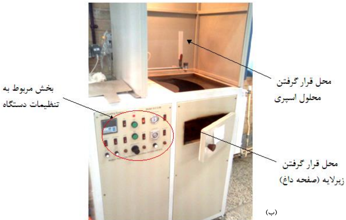
شکل ۴-۱: نمایی از دستگاه اسپری پیرولیز نشان دهنده اجزای مختلف آن
