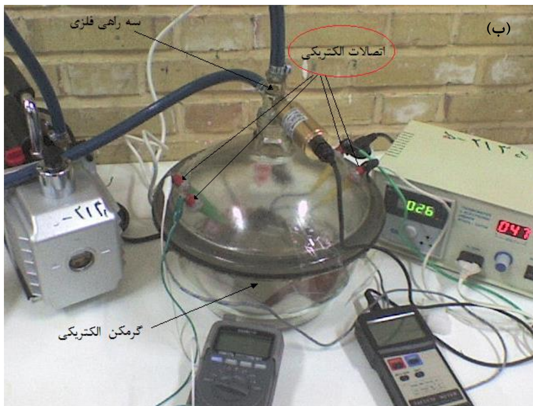
شکل ۴-۶: تصویری از سیستم حسگری برای اندازه‌گیری با تغییر فشار گاز
