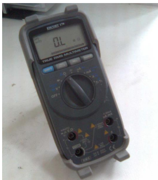
شکل ۴-۸: مولتی متر (اهم سنج) برای اندازه گیری مقاومت الکتریکی
