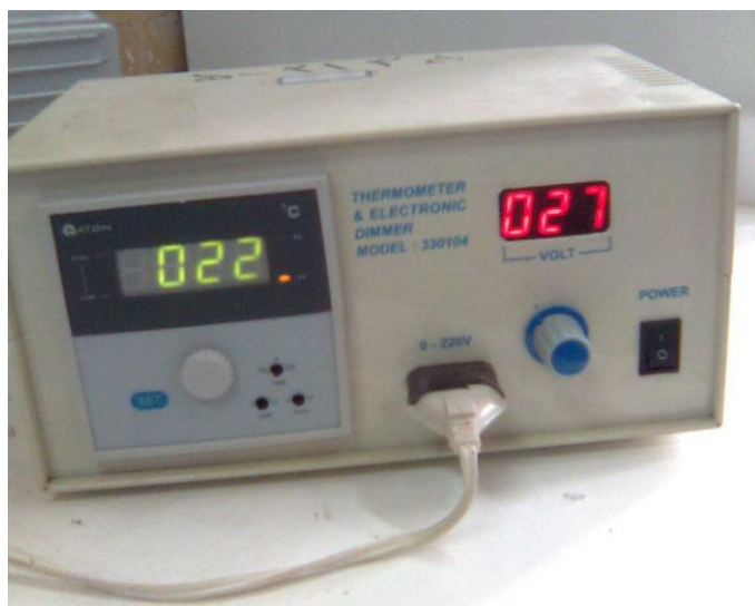
شکل ۴-۹: منبع تغذیه (دایمر- دماسنج) برای گرم کردن هیتر
