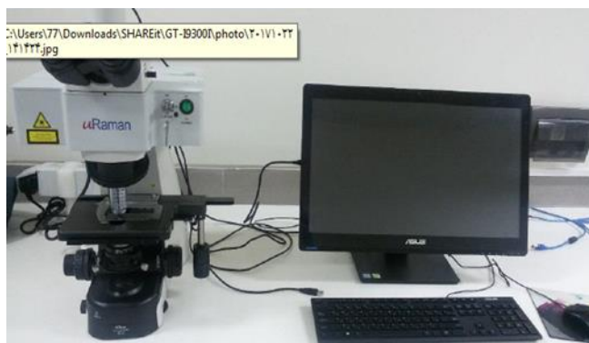
شکل ۲-۵: دستگاه طیف سنجی رامان موجود در آزمایشگاه نانو فیزیک دانشگاه صنعتی شاهرود
