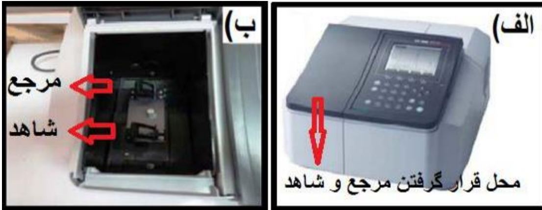
شکل ۲-۴: الف) نمایی از دستگاه اسپکتروفوتومتر مدل SHimadzu UV1800 مستقر در آزمایشگاه نانوفیزیک دانشگاه صنعتی شاهرود (ب) محل قرارگرفتن نمونه های مرجع و شاهد.
