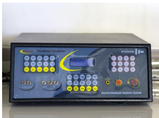
شکل ۲-۶: دستگاه آنالیز الکتروشیمیایی مدل PGS2065 در دانشگاه شاهرود جهت تعیین مشخصه I-V نمونه‌ها.
