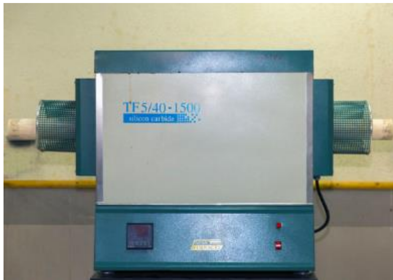
شکل ۳-۳: تصویر کوره تیوپی 1500^{\circ}\text{C} درجه در دانشگاه صنعتی شاهرود برای بازپخت نمونه ها
