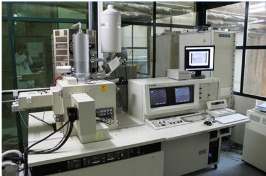
شکل ۳-۲: دستگاه (SEM) مدل Hitachi S-4160 دانشکده فنی دانشگاه تهران
