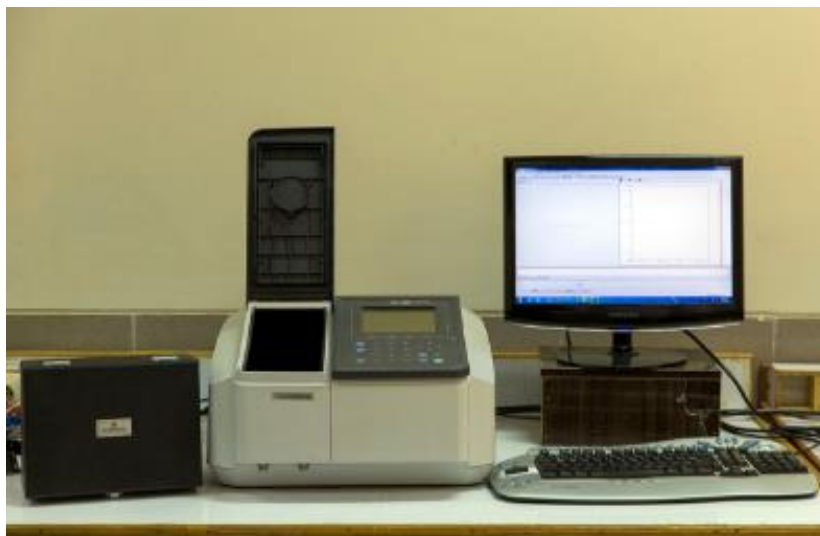
شکل ۲-۹: دستگاه اسپکتوفوتومتر مدل Shimadzu آزمایشگاه اندازه گیری و آنالیز دانشگاه صنعتی شاهرود
