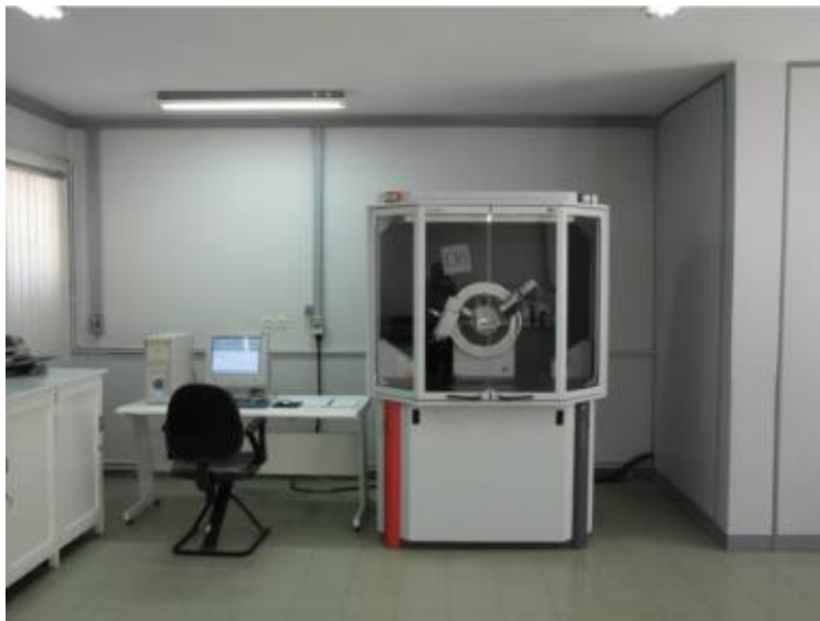
شکل ۲-۴: دستگاه پراش پرتو X (D8-Advance Bruker Cu K \alpha ( \lambda= 0.15406 nm) در دانشگاه دامغان
