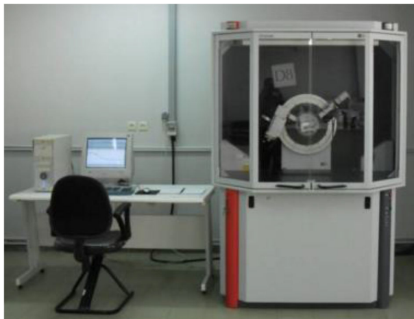
شکل ۲-۵: تصویری از یک دستگاه پراش پرتو X مستقر در دانشگاه دامغان که در این پایان‌نامه برای اندازه‌گیری‌های XRD به کار گرفته شد.
