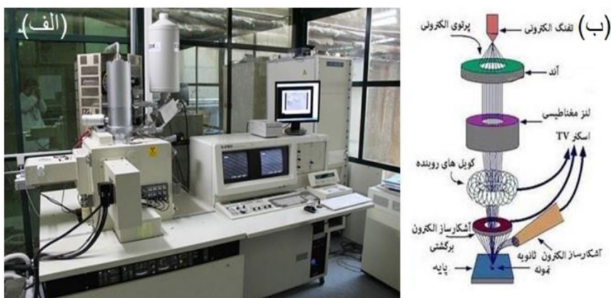
شکل ۲-۳: (الف) نمایی از میکروسکوپ الکترونی روبشی اثر میدانی استفاده شده در پایان نامه، مستقر در دانشگاه تهران. (ب) طرحواره‌ای از اجزاء اصلی یک میکروسکوپ الکترونی روبشی.
