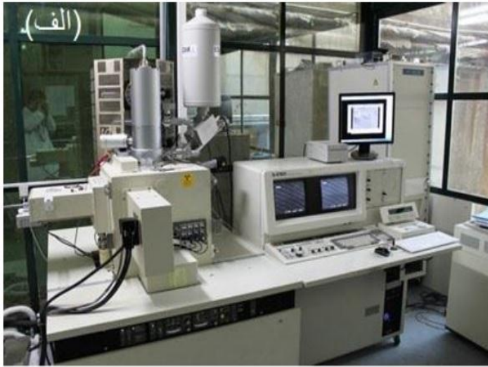
شکل ۲-۲: (الف) نمایی از میکروسکوپ الکترونی روبشی اثر میدانی استفاده شده در پایان نامه. (ب) طرحواره-ای از اجزاء اصلی یک میکروسکوپ الکترونی روبشی.
