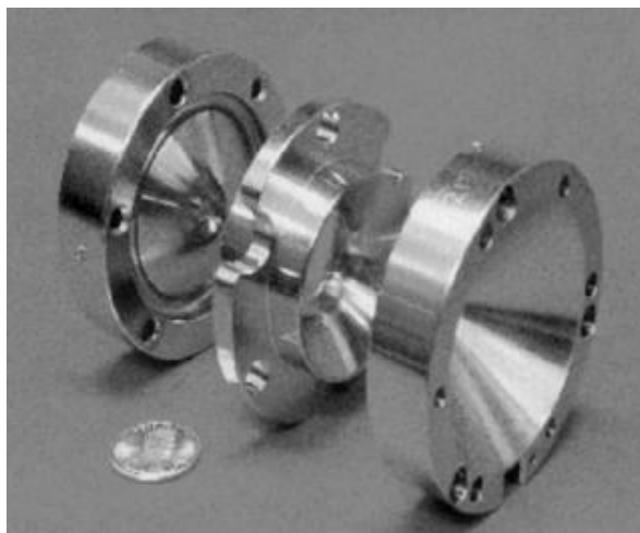
شکل ۱-۴: تصویر الکترودهای یک QIT [۴]
