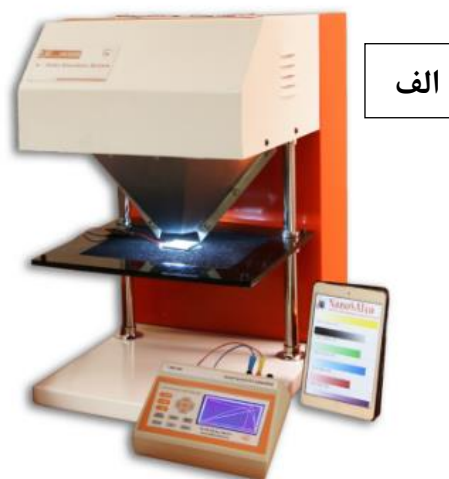
شکل ۳-۷ الف) شبیه ساز خورشید شرکت نانو شات ب) مشخصه یاب پارامترهای سلول خورشید شدت نانو شات
