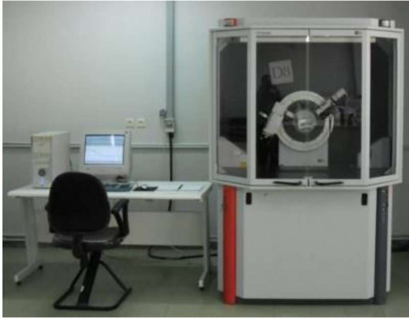
شکل ۳-۳: تصویری از یک دستگاه پراش پرتو X که در این پایان‌نامه برای اندازه‌گیری‌های XRD به کار گرفته شد
