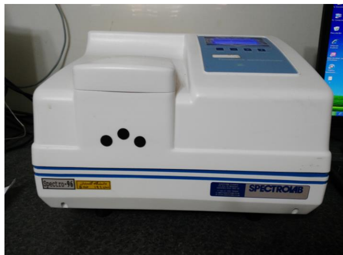
شکل ۲-۵: تصویر دستگاه طیف سنجی فوتولومینسانس موجود در دانشگاه گلستان
