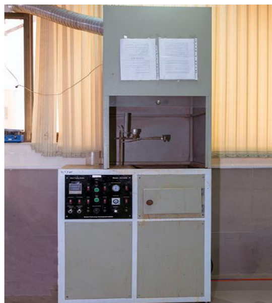
شکل ۲-۱: دستگاه افشانه پیرولیز استفاده شده در این تحقیق موجود در دانشگاه صنعتی شاهرود
