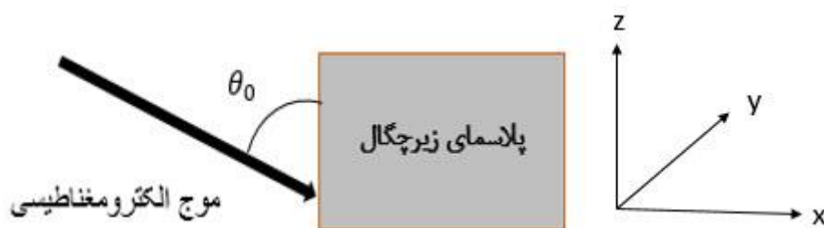
شکل ۳-۱: شماتیک فرود مایل موج الکترومغناطیسی به درون پلاسمای زیرچگال.
