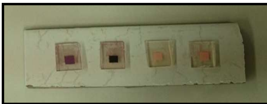
شکل ۴-۱۰: رنگدانه‌های جذب شده بر روی نمونه‌ها به ترتیب از سمت راست: D_1 , D_2 , D_3 , N719
