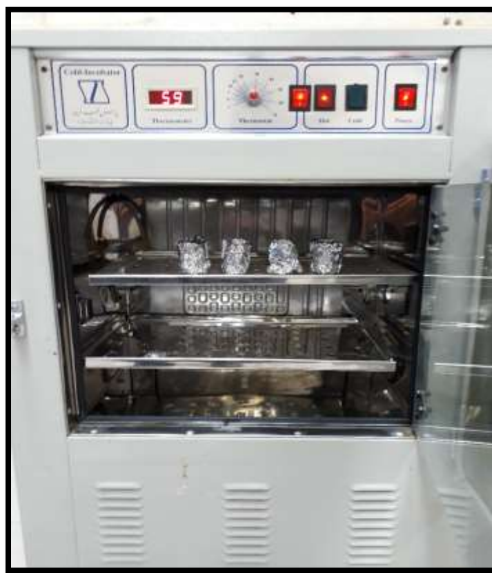
شکل ۴-۹: قرار دادن نمونه‌های غوطه‌ور شده در مواد رنگزا تحت دمای 60^{\circ}\text{C}
