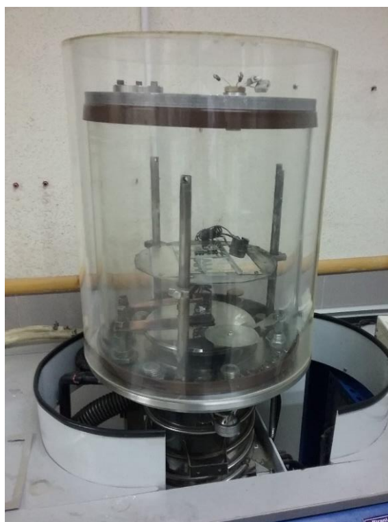
شکل ۴-۵ نمایی از ضخامت سنج بلور کوارتز دستگاه
