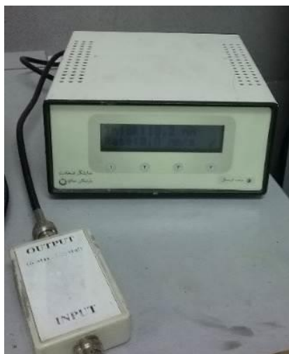
شکل ۴-۵ نمایی از ضخامت سنج بلور کوارتز دستگاه
