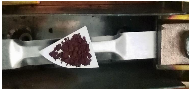
شکل ۴-۴ نمایی از فسفر و آلومینا روی بوته ی تنگستن
