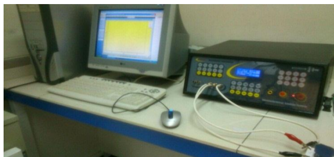
شکل ۹-۲ تصویر دستگاه پتانسیواستات-گالوانوستات استفاده شده متعلق به دانشگاه صنعتی شاهرود.
