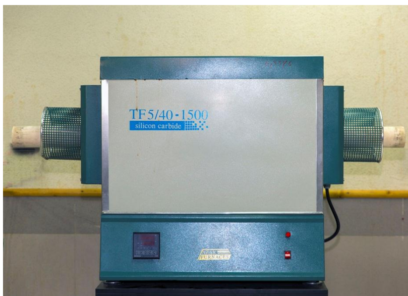
شکل ۳-۳ تصویری از کوره تیوپی TF5/40-1500 متعلق به دانشگاه صنعتی شاهرود.
