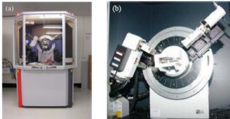
شکل ۵-۲: (a) تصویر دستگاه پراش پرتو X مدل Bruker-AXS در دانشگاه دامغان. (b) محل قرار گیری نمونه.
