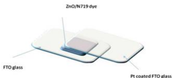
شکل ۴-۲۱: شماتیک سلول خورشیدی رنگدانه ای نانو میله‌ی اکسید روی لایه نشانی شده به روش دکتر بلید
