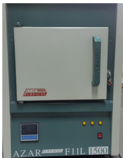
شکل ۴-۱۸: کوره‌ی جعبه‌ای مدل F11L 1500
