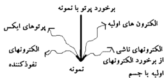
شکل ۳-۲۲: نحوه ی برخورد الکترون‌های دستگاه SEM با نمونه
