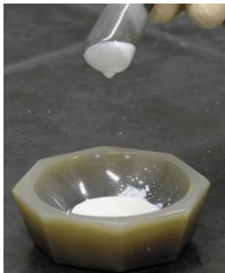
شکل ۴-۱۵: خیسانیدن پودر نانومیله در داخل هاون
