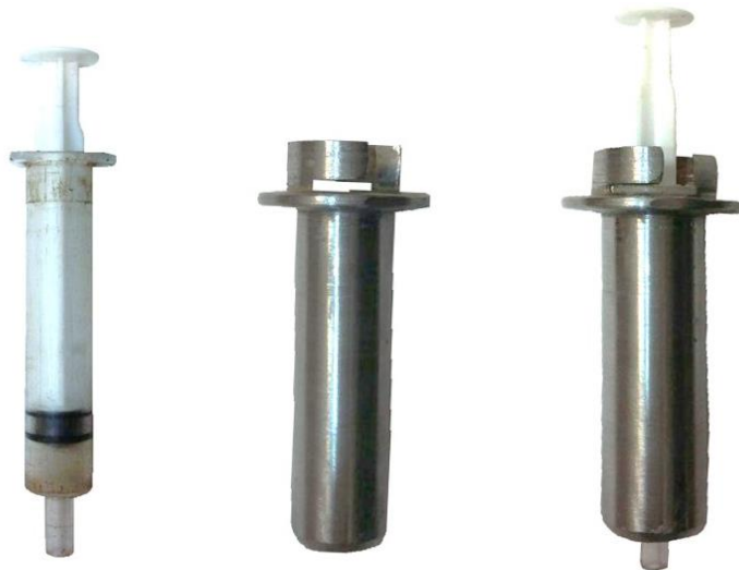
شکل ۳-۷ حفاظ ساخته شده در آزمایشگاه و نحوه قرارگیری سرنگ
