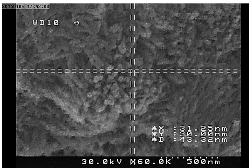
شکل ۴-۱۶: تصویر نانوسیمهای انباشت شده در قالب آلومینا.
