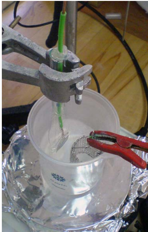
شکل ۳-۱۴: سلول الکتروشیمیایی برای تهیه سیلیکون متخلخل.
