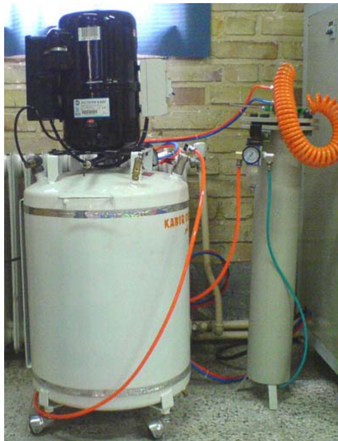
شکل ۳-۷: کمپرسور و صافی دستگاه اسپری پایرولیزیز.
