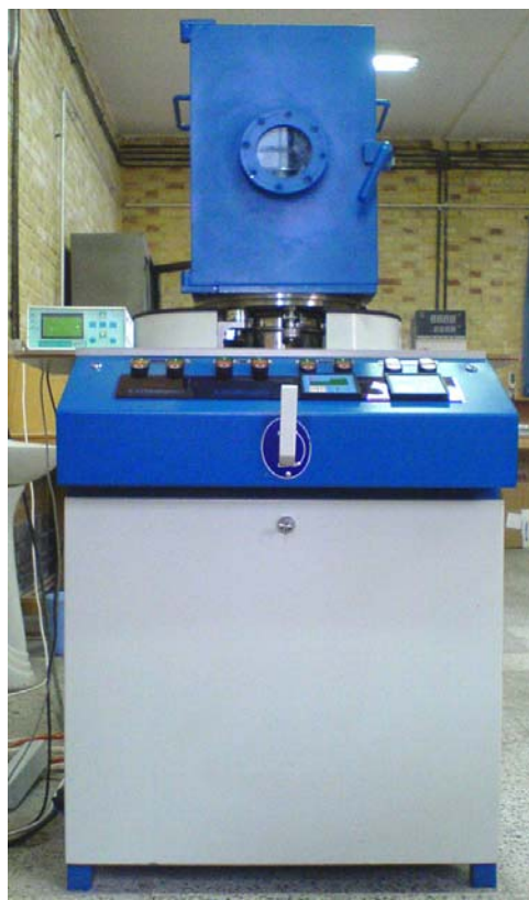
شکل ۳-۸: دستگاه لایه نشانی تبخیر حرارتی در خلا.
