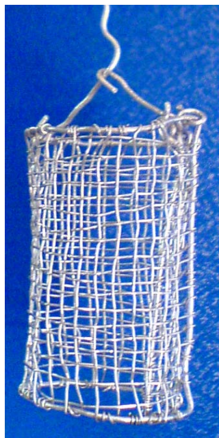
شکل ۳-۱۳: توری پلاتین استفاده شده در سلول الکتروشیمیایی برای متخلخل کردن سیلیکون.
