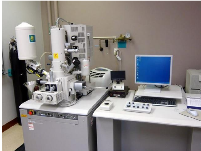
شکل ۳-۳: الف) دستگاه میکروسکوپ الکترونی روبشی گسیل میدانی (FESEM) مدل Hitachi S-4700 مورد استفاده در این پایان نامه، ب) تصویر الگووار از اجزای داخلی دستگاه [۱۹].
