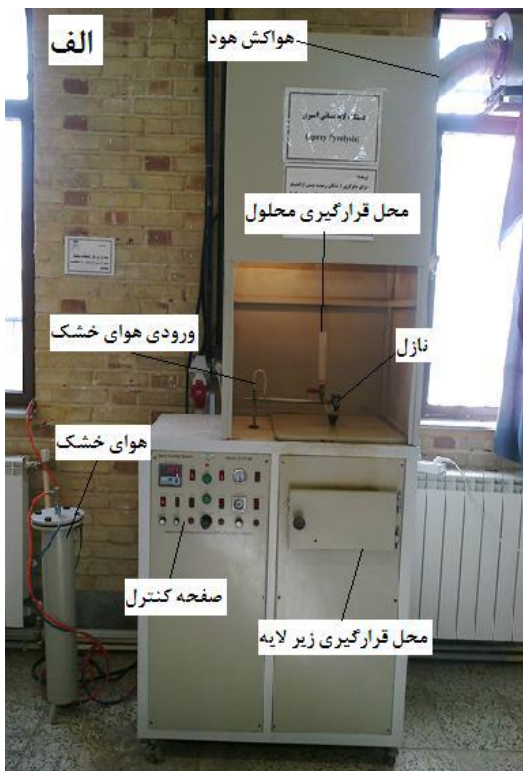
شکل ۳-۱: (الف) دستگاه افشانه پايرولیزیز مدل Spray Coating System.S.C.S.86 استفاده شده در این تحقیق
