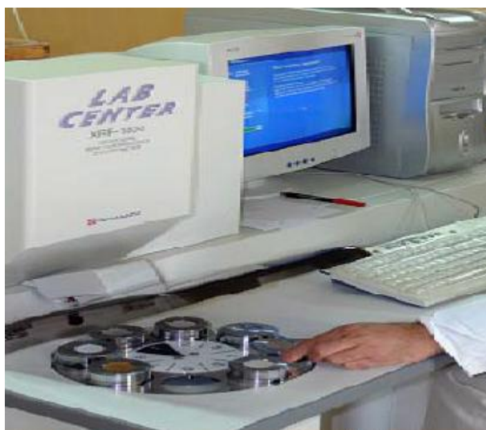
شکل ۳-۹: دستگاه XRF مدل Shimadzo 1800 موجود در دانشکده معدن دانشگاه شاهرود.
