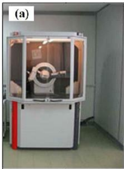
شکل ۳-۵: (الف) تصویری از دستگاه پراش پرتو ایکس مدل Unisance S300 موجود در دانشگاه دامغان که در این پایان نامه از آن استفاده شده است، (ب) محل قرار گرفتن نمونه‌ها.
