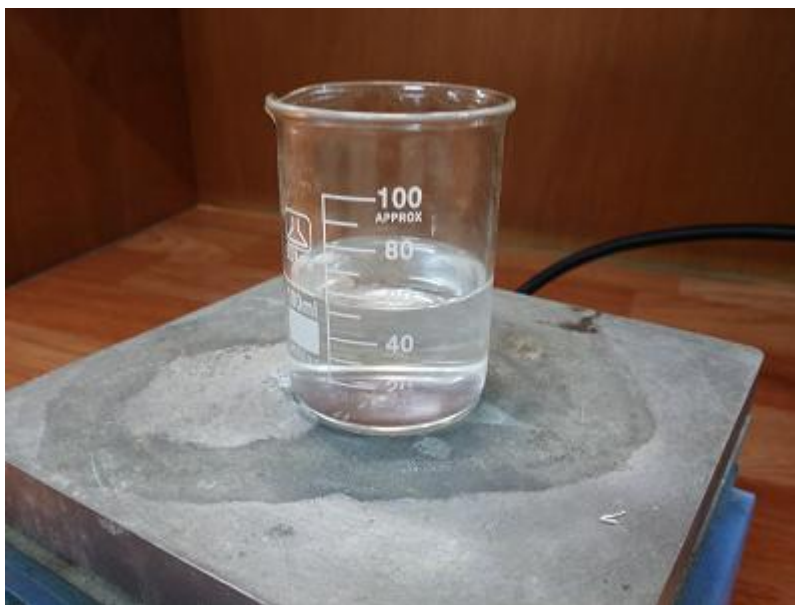
شکل ۴-۱: محلول اولیه آمونیوم مولیبدات تتراهیدرات تهیه شده برای لایه نشانی به روش افشانه پیرولیز.
