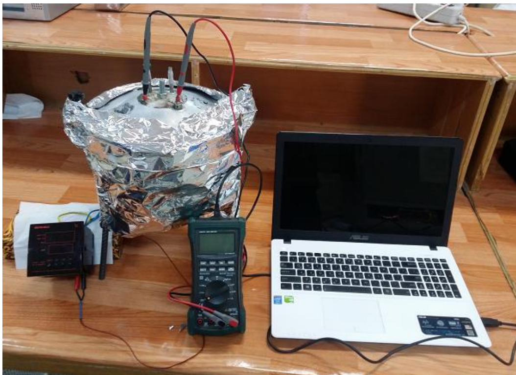
شکل ۳-۱۱ دستگاہ حسگری طراحی و ساخته شده در آزمایشگاه نانوفیزیک دانشگاه شاهرود بر مبنای اندازه‌گیری مقاومت الکتریکی.
