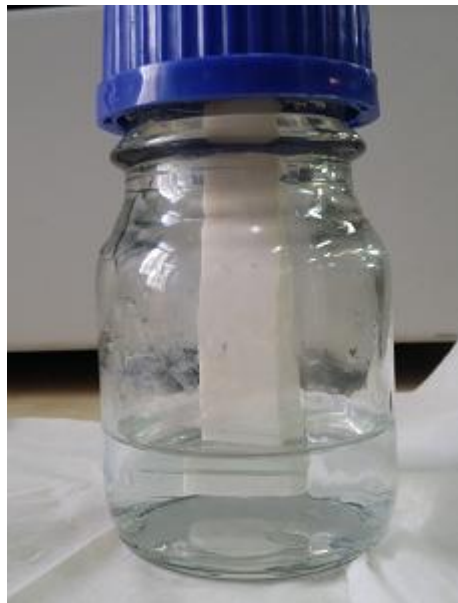
شکل ۴-۸: محلول اولیه و نحوه قرار گرفتن زیر لایه در محلول.
