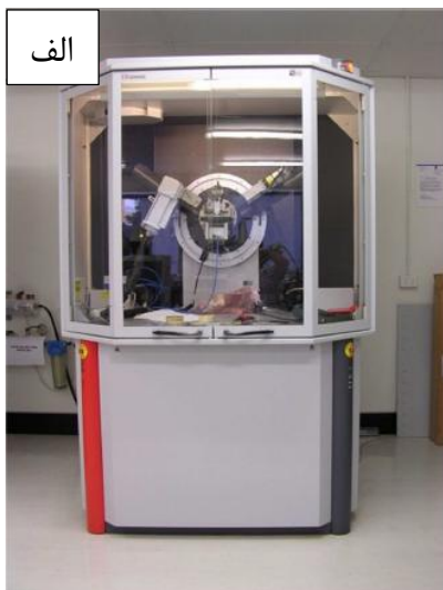
شکل ۲-۳: (الف) تصویری از دستگاه پراش پرتو x مدل Bruker – AXS در دانشگاه دامغان. (ب) محل قرار گرفتن نمونه.
