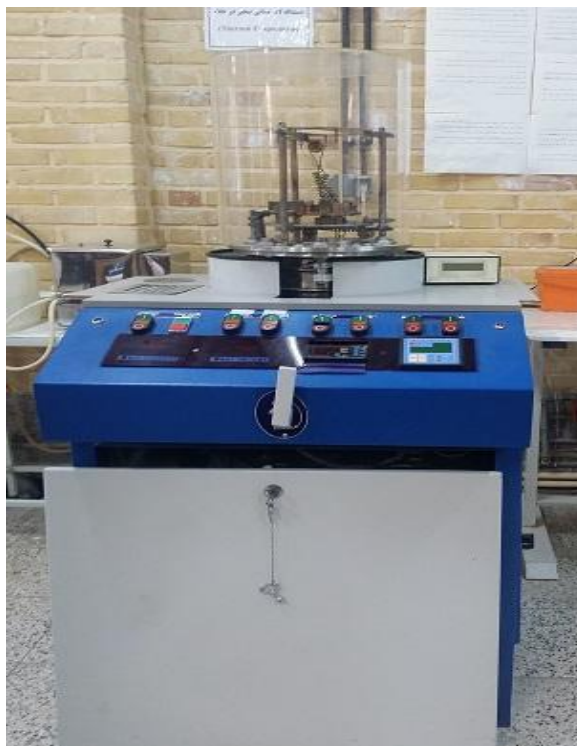
شکل ۳-۹ : دستگاه تبخیر حرارتی موجود در آزمایشگاه نانو فیزیک دانشگاه شاهرود
