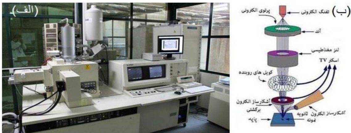
شکل ۳-۱: الف) دستگاه میکروسکوپ الکترونی روبشی گسیل میدانی (FESEM) مدل Hitachi S-41600 که در این پایان‌نامه از آن استفاده شده است، (ب) تصویر الگووار از اجزای داخلی دستگاه [۳۳].
