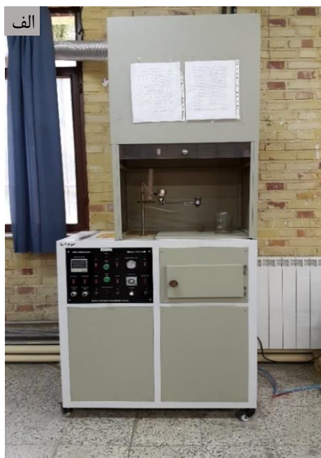
شکل (۳-۵): (الف) دستگاه اسپری استفاده شده در این تحقیق Spray Coating System.S.C.S.86 در دانشگاه شاهرود (ب) طرح الگودار از دستگاه اسپری
