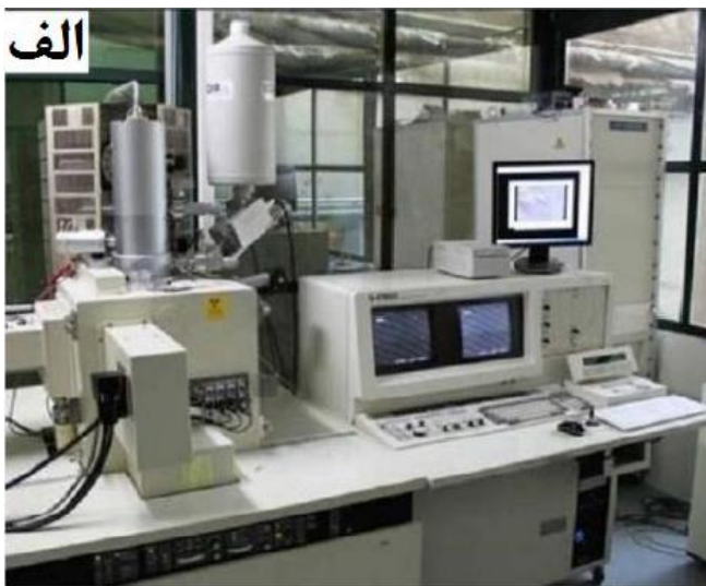
شکل (۱-۳) (الف) نمایی از میکروسکوپ الکترونی روبشی گسیل میدانی (FESEM Hitachi S.4160) واقع در دانشگاه تهران به کار گرفته شده این پایان‌نامه
