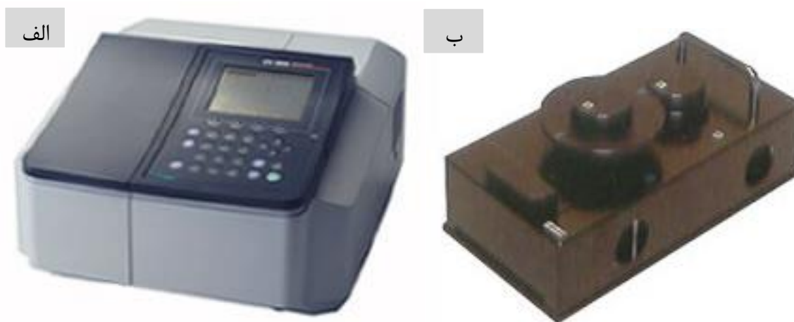
شکل (۳-۳): (الف) دستگاه اسپکتروفوتومتر مدل Shimadzu (UV-Vis-1800) دانشگاه شاهرود. (ب) جایگاه‌های قرارگیری نمونه‌های مرجع و شاهد برای تعیین ضریب عبور و ضریب بازتاب
