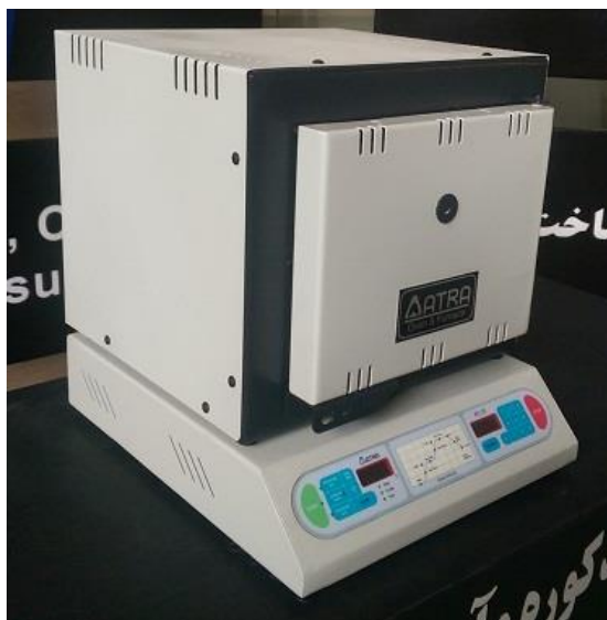
شکل (۳-۴): کوره الکتریکی ۱۲۰۰ درجه در ۴ حجم (۳-۸-۱۸-۶۰) لیتر جهت امور آزمایشگاهی، دانشگاه شاهرود
