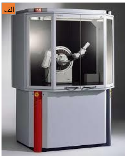
شکل (۳-۲): (الف) دورنمایی از دستگاه پراش پرتو ایکس مدل Bruker-AXS در دانشگاه دامغان (ب) محل قرار گرفتن نمونه
