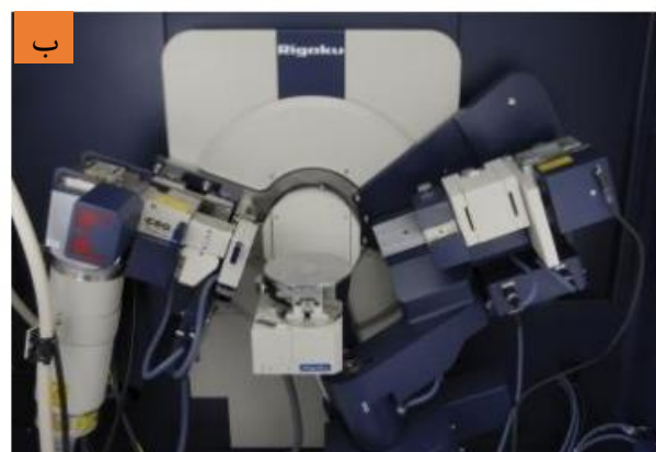
شکل (۳-۲): (الف) دورنمایی از دستگاه پراش پرتو ایکس مدل Bruker-AXS در دانشگاه دامغان (ب) محل قرار گرفتن نمونه
