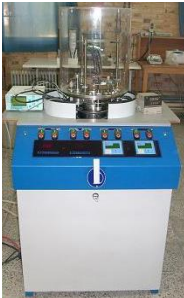
شکل ۳-۷: دستگاه تبخیر حرارتی موجود در دانشگاه شاهرود
