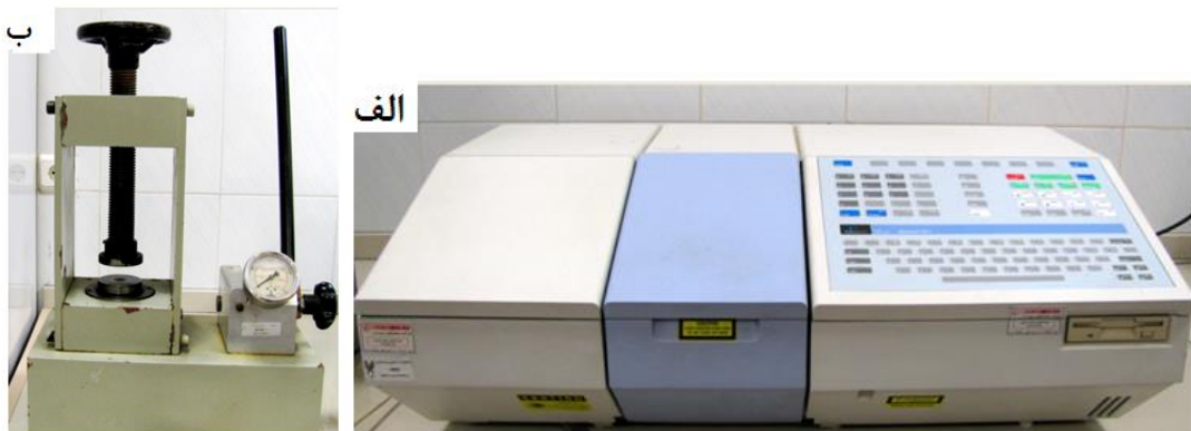
شکل ۳-۵: (الف) دستگاه FT-IR (مدل Spectrum RX1 ساخت شرکت PerkinElmer) موجود در دانشگاه آزاد واحد شاهرود و (ب) دستگاه پرس برای ساختن قرص
