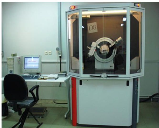
شکل ۳-۳: دستگاه پراش پرتو ایکس مدل (Advance Bruker D8) در دانشگاه دامغان
