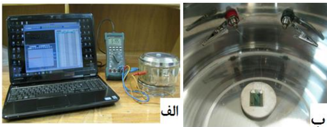
شکل ۳-۸: (الف) سامانه حسگری دست ساز مورد استفاده جهت انجام آزمایش‌های حسگری و (ب) داخل محفظه حسگری
