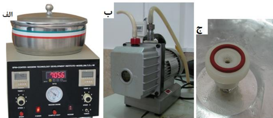
شکل ۳-۶: (الف) دستگاه لایه نشانی چرخشی (SPIN-COATER) مدل S.C.S.86 و (ب) پمپ روتاری دستگاه و (ج) محل قرارگیری نمونه
