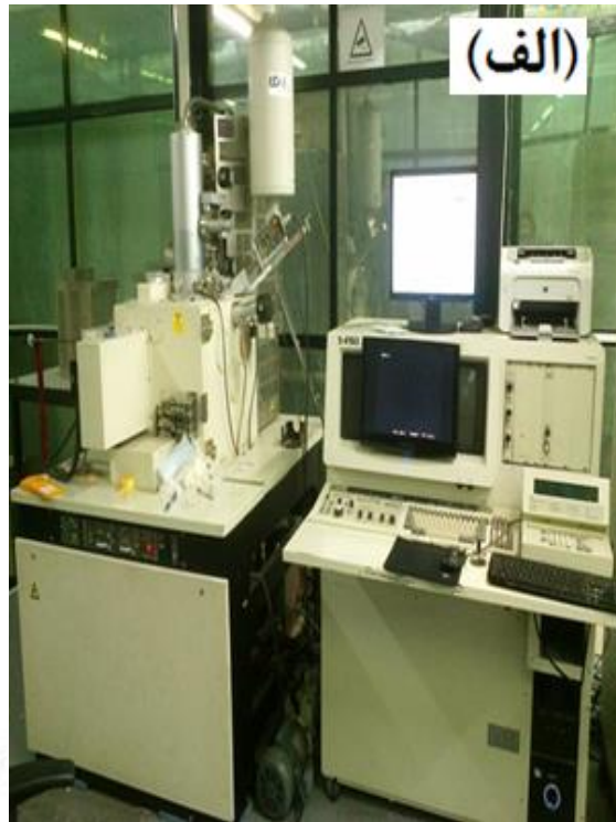
شکل ۳-۱: (الف) میکروسکوپ الکترونی گسیل میدانی مدل Hitachi s.4160 در دانشگاه تهران و (ب) نمایی الگو وار از ساختار داخلی میکروسکوپ الکترونی روبشی گسیل میدانی.
