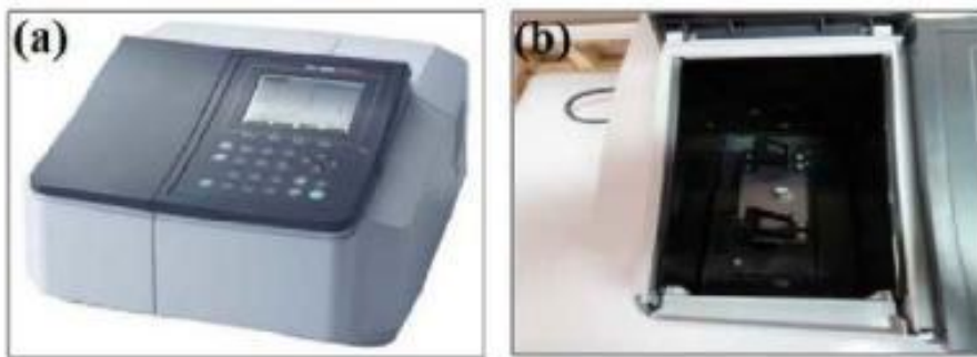
شکل ۴-۲: الف) دستگاه اسپکتروفوتومتر مدل Shimadzo (UV-Vis, 1800) دانشگاه صنعتی شاهرود (ب). جایگاه‌های قرارگیری نمونه‌های آزمایشی و شاهد برای تعیین ضرایب عبوری و جذبی.
