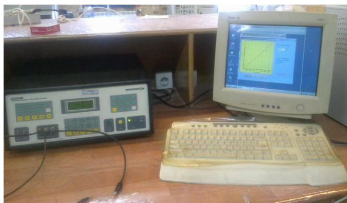
شکل ۸-۲: تصویر دستگاه نمایشگر I-V (مدل + BHP 2063 شرکت به پژوه) به کار گرفته شده در آزمایشگاه دانشگاه صنعتی شاهرود.
