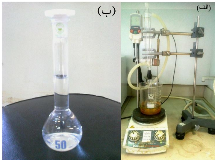
شکل ۳-۴: الف) مرحله حل شدن پودر \text{WO}_3 در حلال آمونیاک در حال جوش بر روی صفحه داغ (ب) محلول تنگستات آمونیوم بدست آمده.
