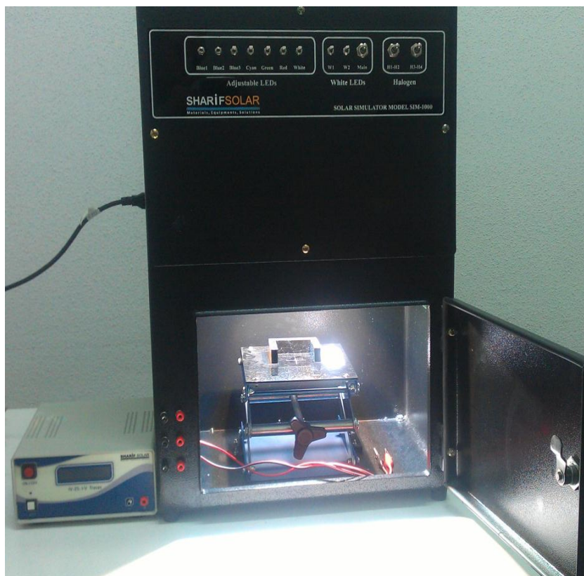
شکل ۵-۱۲: شبیه‌ساز طیف خورشیدی شرکت شریف سولار مدل SIM-1000
