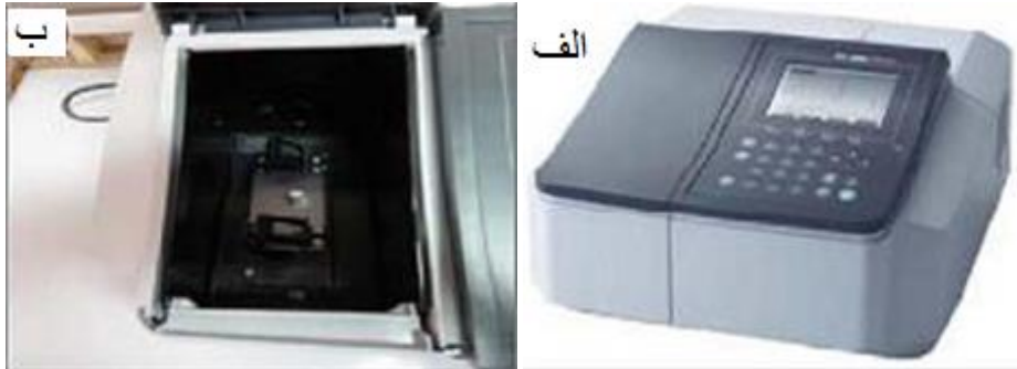
شکل ۳-۳: الف) یک دستگاه اسپکتروفوتومتر. ب) جایگاه های قرارگیری نمونه های مرجع و شاهد.
