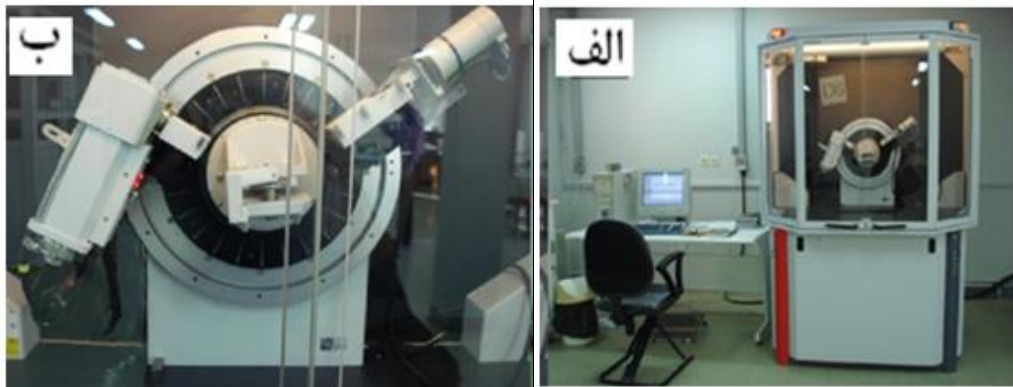
شکل ۳-۱: الف) دستگاه پراش پرتو X (ب) محل قرار گرفتن نمونه.
