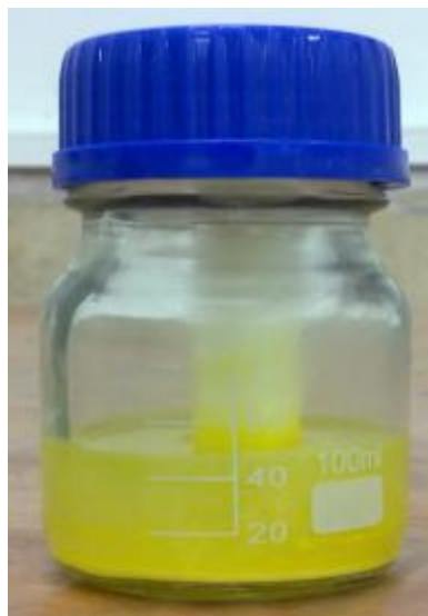
شکل ۲-۱۰: محلول مورد استفاده در روش هیدروترمال بعد ۲۴ ساعت گرمادهی
