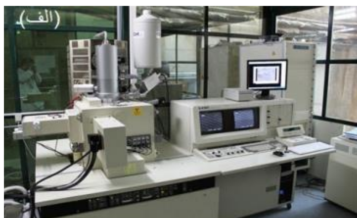
شکل ۱-۲: (الف) دستگاه میکروسکوپ الکترونی روبشی گسیل میدانی (FESEM) مدل Hitachi S-41600 که در
