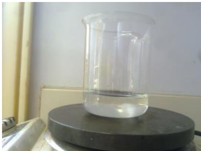
شکل ۲-۷: محلول اولیه آمونیوم تنگستات تهیه شده برای لایه نشانی به روش اسپری پایرولیزیز [۲۸].
