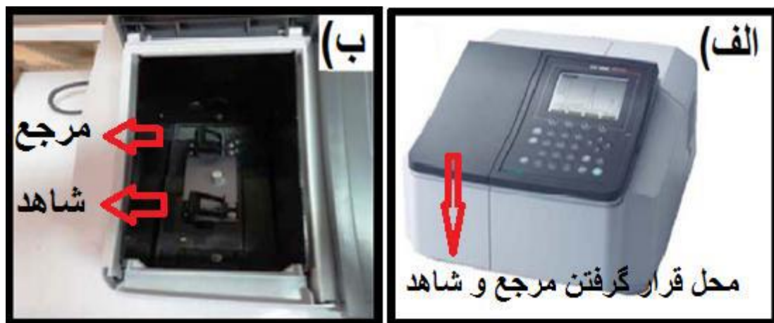
شکل ۴-۲: الف) دستگاه اسپکتروفوتومتر (Shimadzu UV-1800) دانشگاه صنعتی شاهرود ب) محل قرارگیری مرجع و شاهد.
