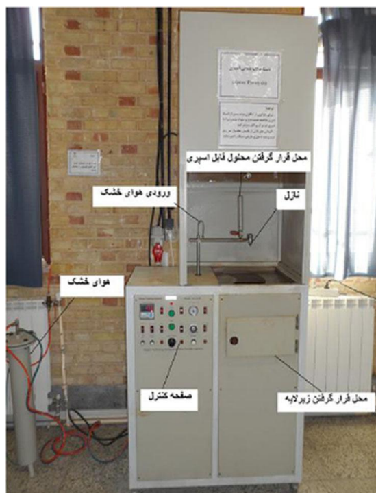
شکل ۳-۱: دستگاه تجزیه گرمایی افشانه‌ای (Spray Coating System .S.C.S.806) استفاده شده برای تهیه لایه‌های نازک اکسید نیکل در دانشگاه شاهرود.
