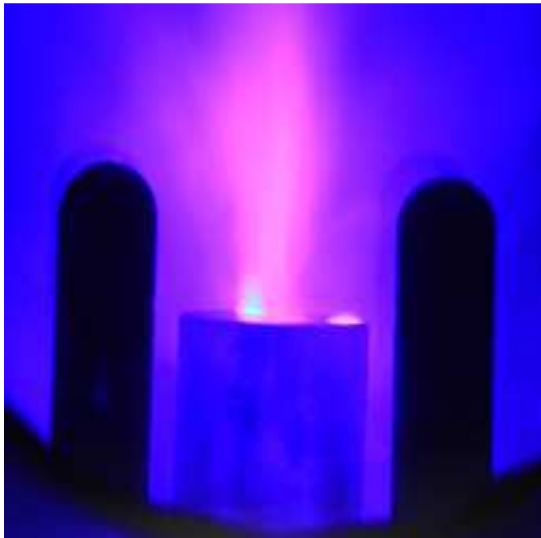
فشار 1/6 torr ولتاژ 9 KV طول عایق 4 cm
