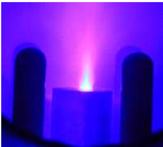
فشار 0.8 \text{ torr} ، ولتاژ 9 \text{ KV} ، طول عایق 4 \text{ cm}
