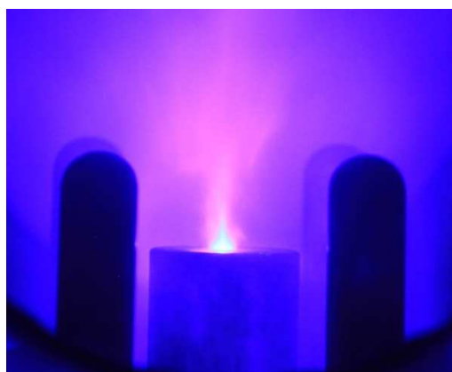
فشار ۱/۲ torr، ولتاژ ۹ KV، طول عایق ۴/۵cm
