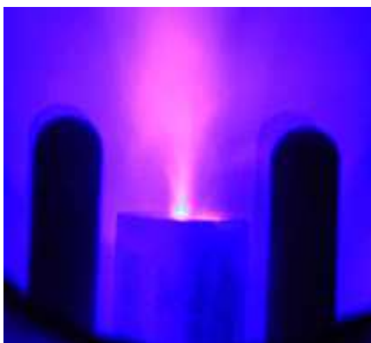
فشار 1.2 \text{ torr} ، ولتاژ 9 \text{ KV} ، طول عایق 4 \text{ cm}
