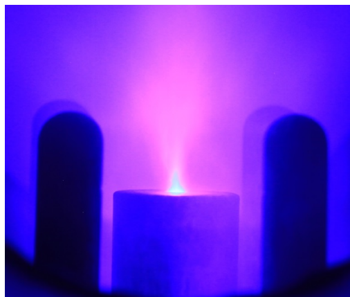
فشار 1/4 torr، ولتاژ 9 KV، طول عایق 4/5 cm
