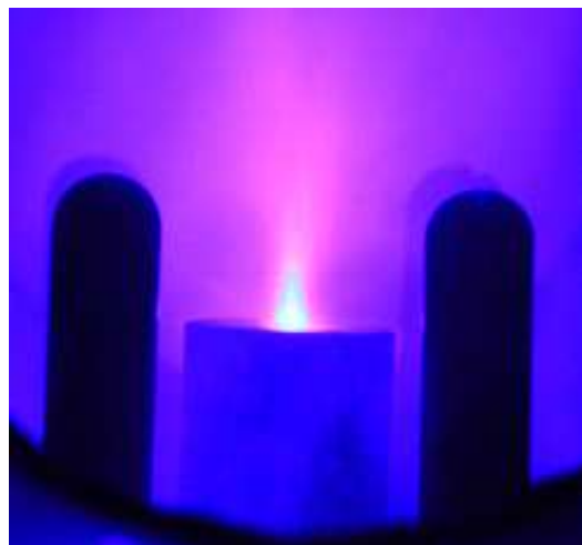
فشار 1 \text{ torr} ، ولتاژ 9 \text{ KV} و طول عایق 4 \text{ cm}
