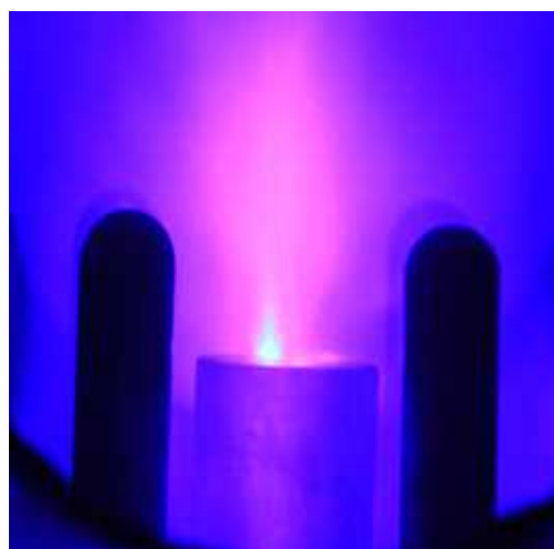
فشار 1.4 \text{ torr} ، ولتاژ 9 \text{ KV} ، طول عایق 4 \text{ cm}
