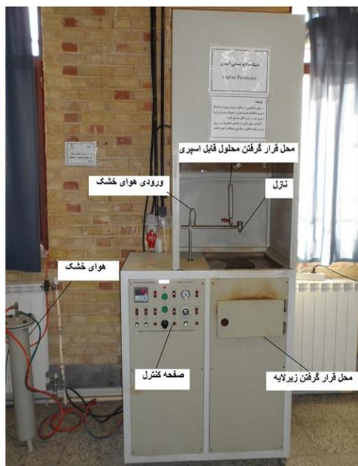
شکل ۳-۲: دستگاه اسپری (Spray Coating System.S.C.S.806) استفاده شده برای تهیه لایه ها اکسید نیکل در دانشگاه صنعتی شاهرود.
