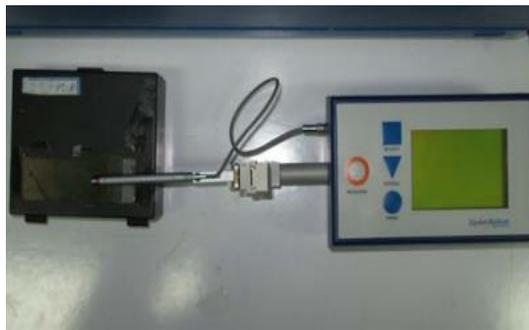
شکل ۲-۴: دستگاه اندازه گیری ضخامت سطحی لایه ها دانشگاه صنعتی شاهرود.
