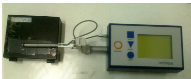
شکل ۲-۷: دستگاه اندازه گیری ضخامت نمونه ها در دانشگاه شاهرود.
