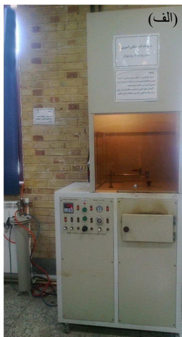
شکل ۲-۳: (الف) دستگاه اسپری پیرولیزیز (Spray Coating System.S.C.S.86) در دانشگاه شاهرود،
