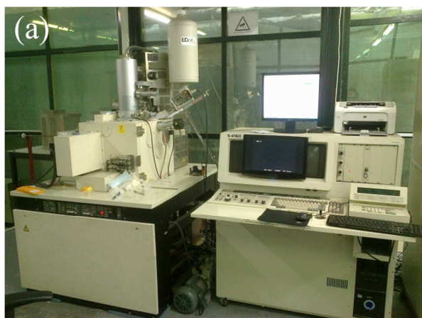
شکل ۱-۲: (a) نمایی از میکروسکوپ الکترونی روبشی اثر میدانی (FESEM ; Hitachi S-4160) بکار
