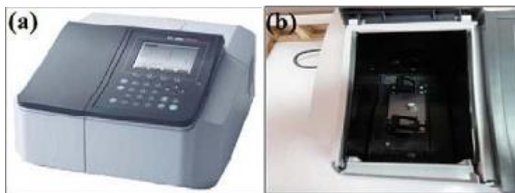
شکل ۲-۴- (a) - دستگاه اسپکتروفوتومتر Shimadzu (UV-1800) در دانشگاه صنعتی شاهرود. (b) - جایگاه های قرار گیری نمونه های مرجع و شاهد.
