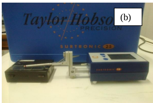
شکل ۳-۳- (a) طرحی از نمونه آماده شده برای ضخامت سنجی (b) دستگاه اندازه گیری سطحی سورترونیک در
