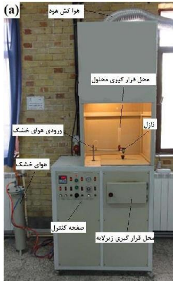
شکل ۳-۲- دستگاه اسپری پایرولیز به کار گرفته شده در دانشگاه شاهرود.
