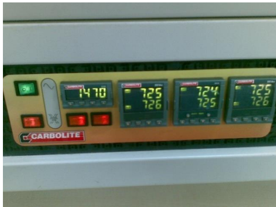
شکل (الف-۳) : کنترلرهایی با تنظیم برنامه دمایی کوره
