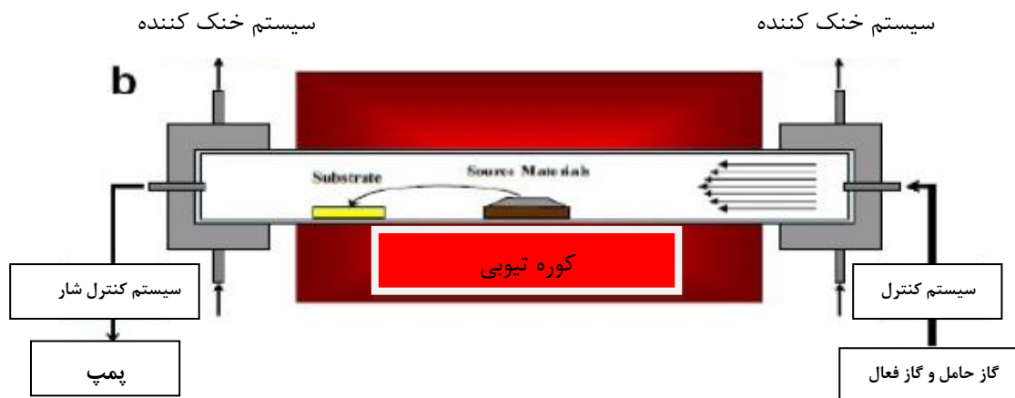
شکل ۱-۵: شکل شماتیک دستگاه سنتز به روش لایه نشانی شیمیایی در فاز بخار (CVD)
