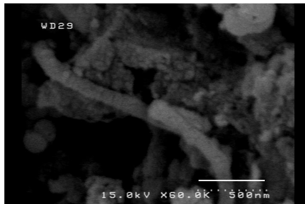
شکل ۴-۱۱: تصویر SEM نانوسیم‌های نیتريد آلومینیوم سری C1 (نمونه‌های سنتز شده با ۱ درصد منگنز و ۰/۳۵ گرم پودر Al)
