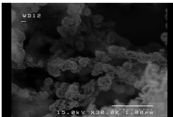
شکل ۴-۹: تصویر SEM نانوسیم‌های نیتريد آلومینیوم سری B ۳ که تشکیل نانوسیم‌هایی با قطر متوسط ۱۰ nm را نشان می‌دهد.
