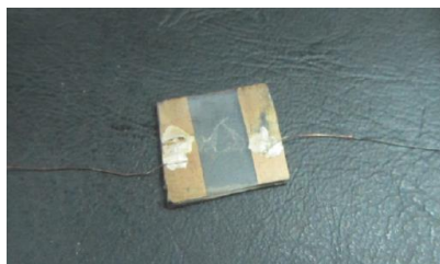
شکل ۳-۱۰: قطعه حسگری آماده شده با لایه نازک NiO سنتز شده به روش اسپری پیرولیز
