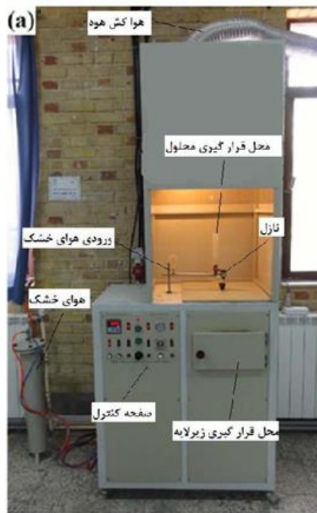
شکل ۳-۱: دستگاه اسپری استفاده شده در این تحقیق Spray Coating System.S.C.S.86 در دانشگاه شاهرود.
