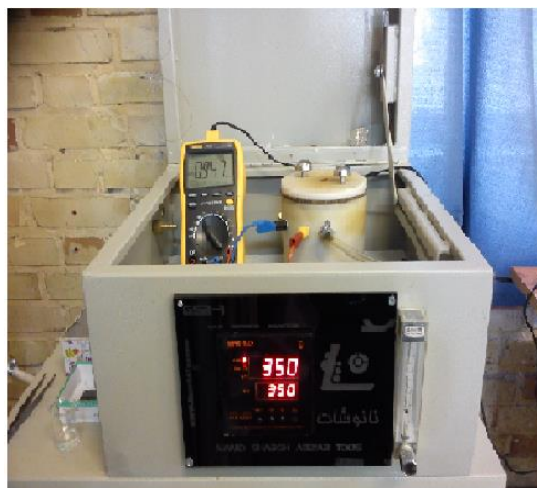
شکل ۳-۸: رآکتور اندازه‌گیری حسگری به کار رفته
