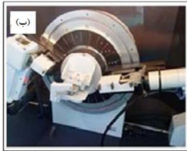
شکل ۴-۱: (الف) دورنمایی از دستگاه پراش پرتو X مدل Bruker-AXS در دانشگاه دامغان (ب) محل قرار گرفتن نمونه
