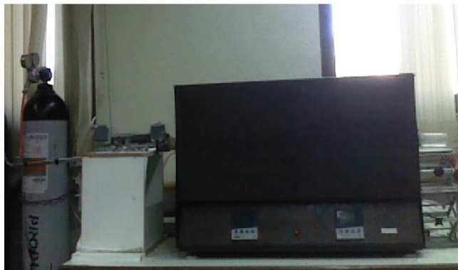
شکل ۳-۳: تصویر کوره الکتریکی و متعلقات آن (آزمایشگاه تحقیقاتی نانوفیزیک دانشگاه صنعتی شاهرود)
