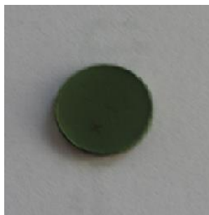
شکل ۳-۷: تصویر قرص بعد از عملیات حرارتی.
