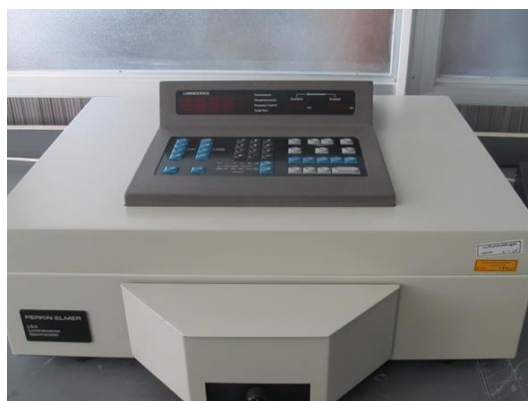
شکل ۲-۹: دستگاه اسپکتروفوتومتر فلوئورسانس پژوهشگاه مواد و انرژی کرج.
