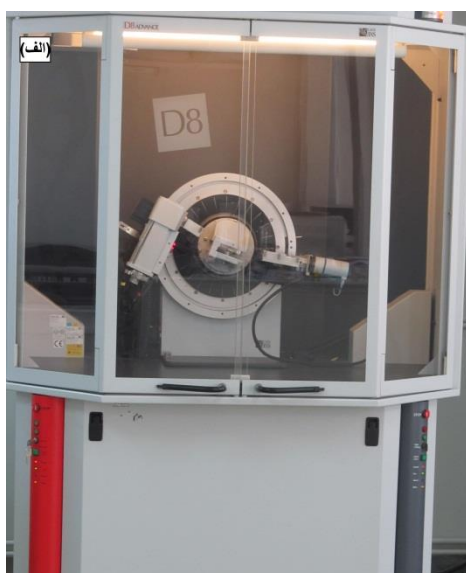
شکل ۲-۲: (الف) دورنمایی از دستگاه پراش پرتوایکس مدل Bruker-AXS در دانشگاه دامغان (ب) محل قرار گرفتن نمونه.
