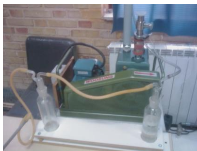
شکل ۳-۴ سیستم گاز و گازشوی بکار رفته در کوره الکتریکی
