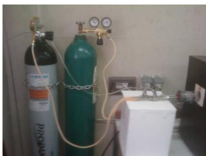
شکل ۳-۴ سیستم گاز و گازشوی بکار رفته در کوره الکتریکی
