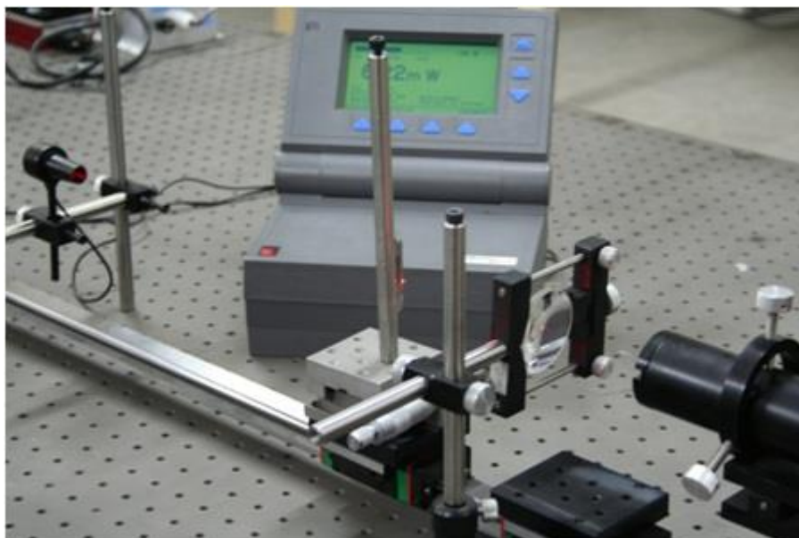
شکل ۵-۹ چیدمان آزمایشگاهی روبش-Z با دریچه باز
