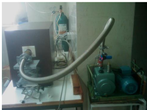
شکل ۳-۳ سیستم خلا بکار رفته در کوره الکتریکی
