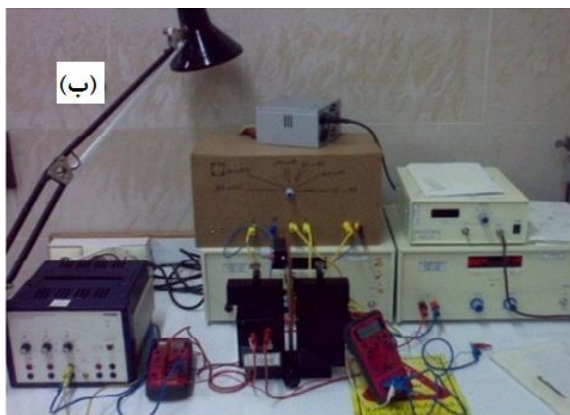
شکل 2-7: (الف) شماتیکی از طرح آزمایش اثر هال، (ب) تصویر دستگاه بکار گرفته شده در آزمایشگاه صنعتی شاهرود.
