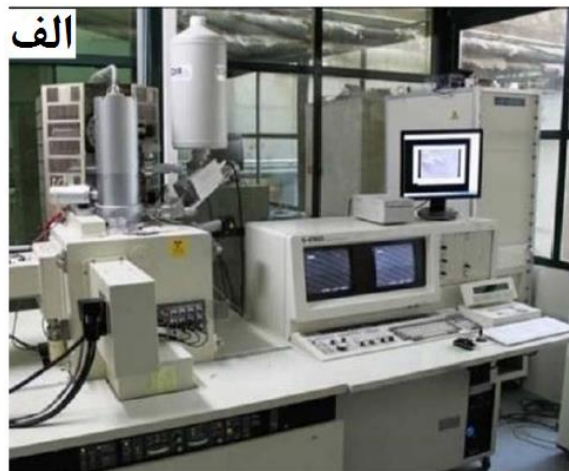
شکل ۲-۱: (الف) نمایی از میکروسکوپ الکترونی روشی گسیل میدانی SEM بکار گرفته شده در مورفولوژی سطح نمونه‌ها در دانشگاه تهران (ب) تصویر شماتیک از اجزاء داخلی مسیر عبور باریکه الکترونی تا سطح نمونه [۲۲].
