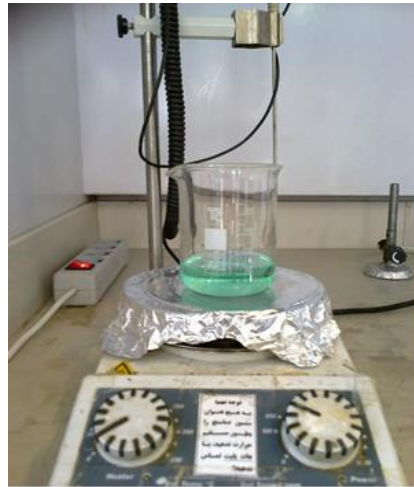
شکل ۳-۳: محلول کلرید نیکل بدست آمده برای لایه‌نشانی.
