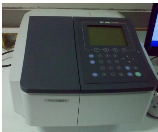
شکل ۲-۳: (الف) دستگاه اسپکتروفوتومتر (shimadzu UV-1800) دانشگاه صنعتی شاهرود. (ب) محل قرارگیری مرجع و شاهد.
