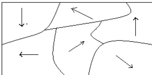
شکل ۲-۳: نواحی یا حوزه های مغناطیسی در یک ماده فرومغناطیس.
