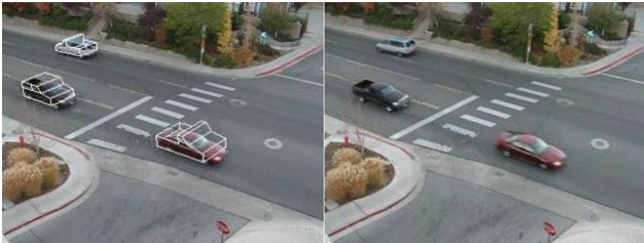
شکل ۲-۱۴: تصویر اصلی و استفاده از مدل شیء در تصویر [۱۰].
